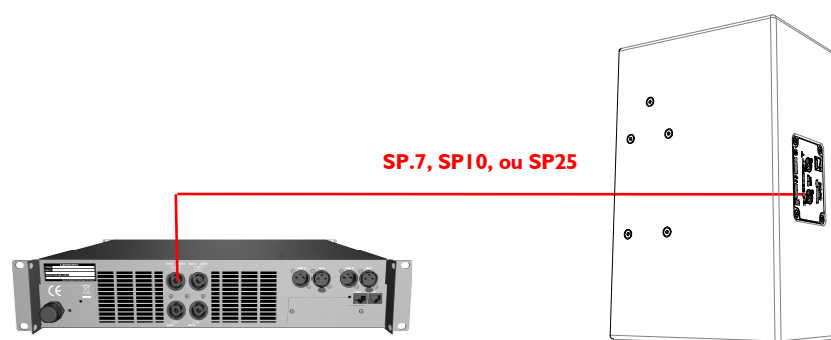
Figure 3 : Raccordement d'une 12XTi au canal I du LA4 / LA4X
