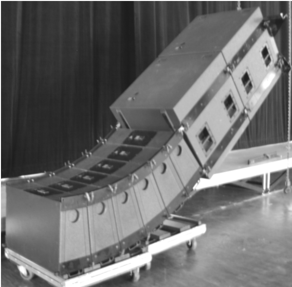
Figure 21: Accrochage du dV-DOSC en-dessous du dV-SUB (procédure 1)
