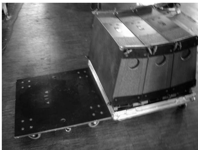
(i) Les dV-DOSC sont préattachés par blocs de 3.
