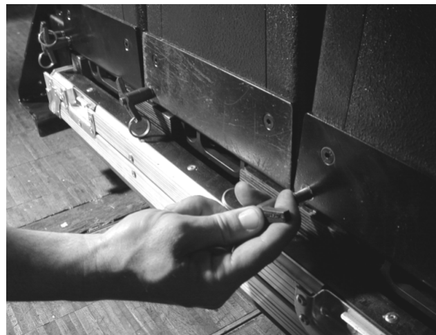
(ii) Goupiller la partie avant des dV-DOSC en utilisant des dV-PIN25.
