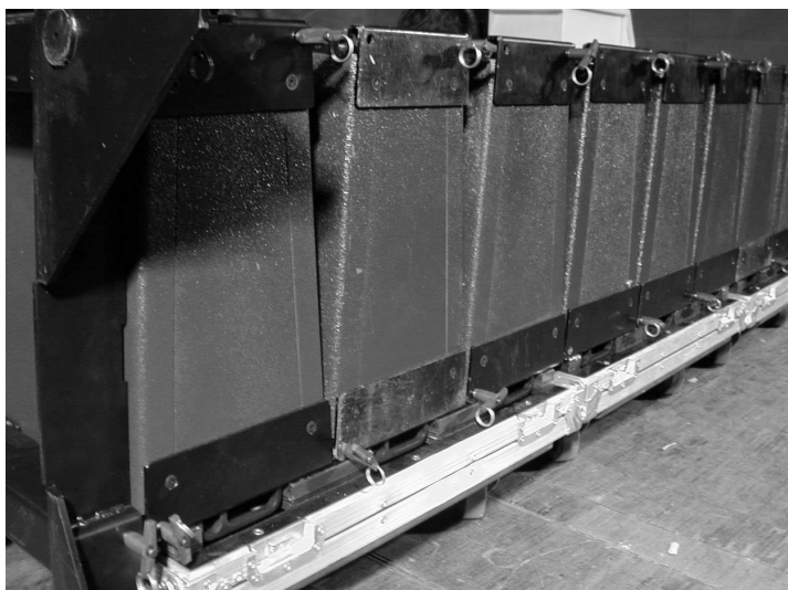
(vi) Les dV-BUMP sont attachés, les dV-ANGLE préattachés.
