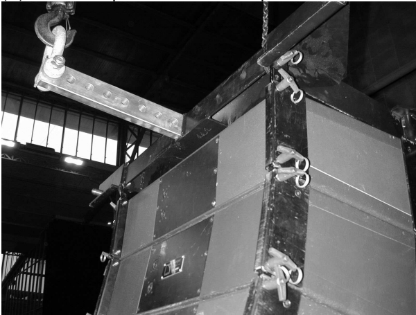
(xiii) Avec un point d'accroche à l'arrière (point n°16), 12 dV-DOSC avec un angle de 7.5^\circ nous donnent une couverture de 90^\circ .
