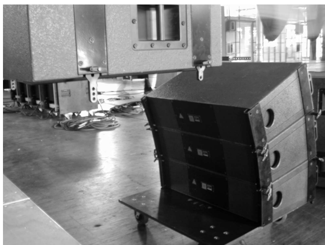
(i) Les dV-DOSC sont préattachés par blocs de 3.
