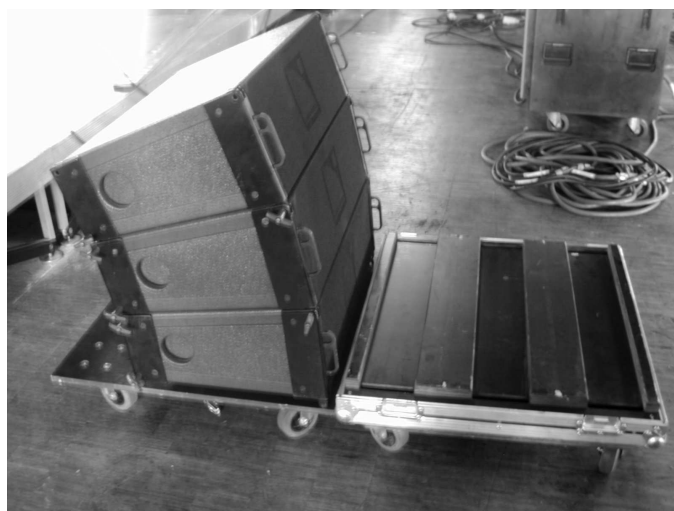
(ii) Basculer les dV-DOSC sur le chariot du dV-SUB.
